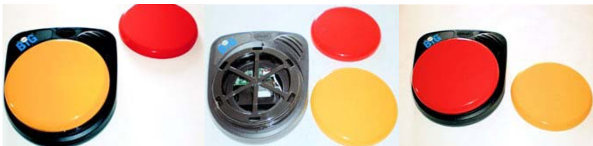
Bild 1: Kappen lassen sich mit einem Handgriff auswechseln.
