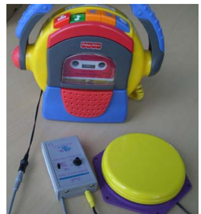
So sieht die Reihenfolge aus: Taster – Switch Latch & Timer – Batterieunterbrecher (im Gerät)
