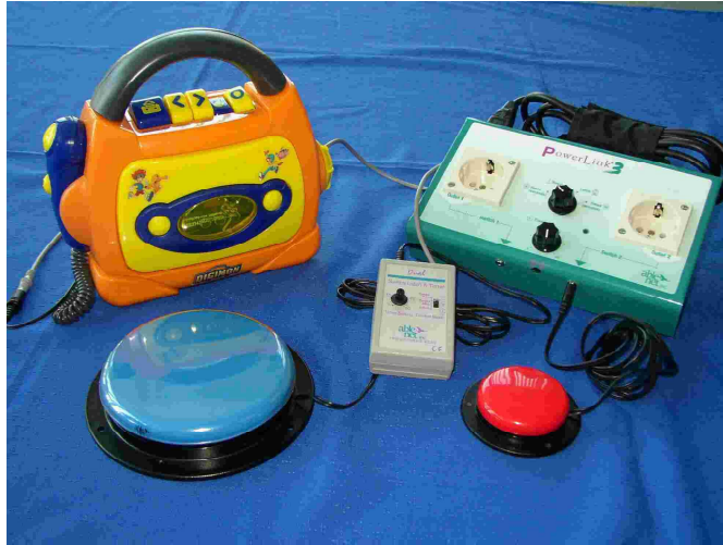
Abbildung 1: Einfache Schaltsysteme: BigRed -Taste mit Switch , Latch & Timer und Kassettenrekorder; Netzschaltkasten PowerLink3 mit Taste JellyBean . (Quelle: privat)
